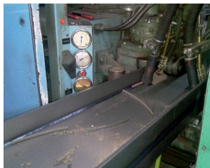
■ Rys. 5. Maszyna do automatycznego spawania łukiem krytym [9]
