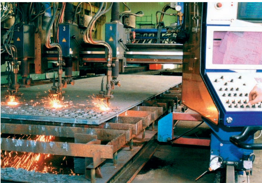
■ Rys. 4. Proces cięcia blachy za pomocą: a) wypalarki gazowej [9], b) przecinarki plazmowej CNC [9]
