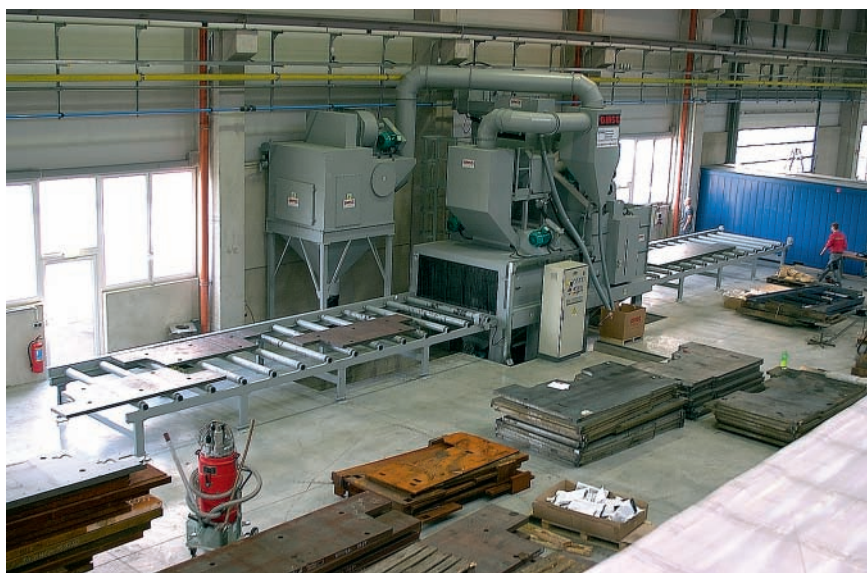
■ Rys. 7. Przelotowe urządzenie śrutujące Lanco firmy Shot Blasting [7]
