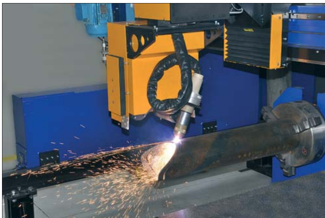
Głowica 3D używana do fazowania rury
