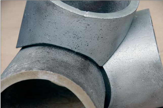
Złożenie rur ze spoiną czołową
