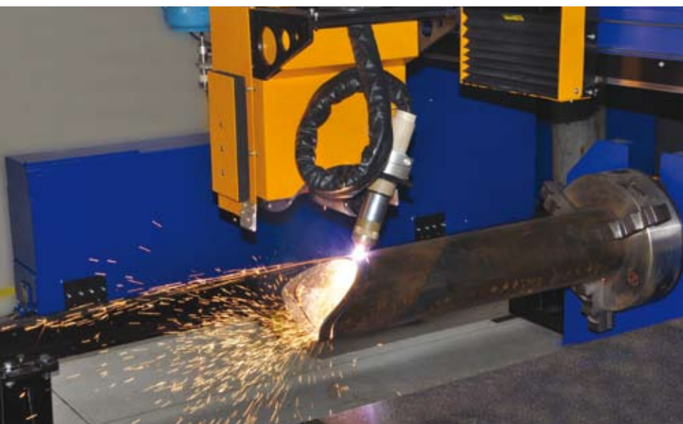
Plazma; fazowanie rury na obrotniku
