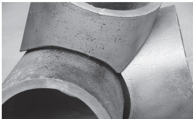
Złożenie rur ze spoiną czołową
